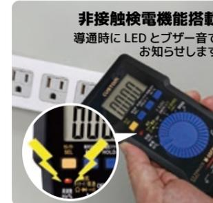
非接触検電機能搭載 導通時に LED とブザー音でお知らせします
