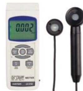
データロガー紫外線強度計 **UV-37SD**
