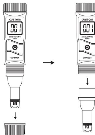
センサー交換時には、必ず電源をOFFにしてから作業を行ってください。また、センサー及びセンサー固定キャップ④をしっかりと取り付けないと水が浸入して故障の原因となりますので、十分にご注意ください。センサー交換時は電池カバー①を取付けたまま行って下さい。
