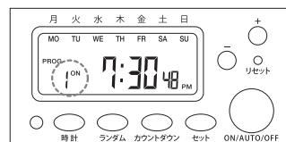
6. 「+」のボタンを押して“1<sup>OFF</sup>”を選択し終了時間(OFF)の設定を開き始めます。設定方法は2~5を繰り返します。
