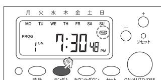
ランダムボタンを押すと…“RND”が表示され、実際タイマー動作が、2~32分の間で自動的に無作為に時間を選び、タイマーの動作をわざと遅らせることが出来るよ。これは防犯対策などで、電気を毎日ずらした時間に点灯させることができるね。その他にも用途はいろいろあるから、試してみてね。
