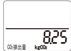
積算電力量、積算電気料金、CO<sub>2</sub>排出量は本製品をコンセントから抜いても保持されます。
