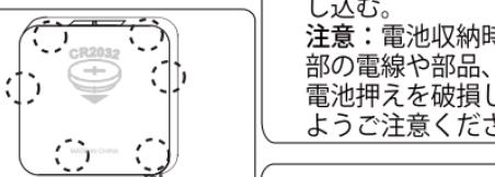
②①でできた隙間にケースオープナーを挿し込み、6か所の爪を外す。
