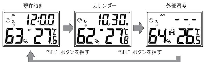
※ 外部センサーを外しても表示が更新されるまでは温度表示されています。
