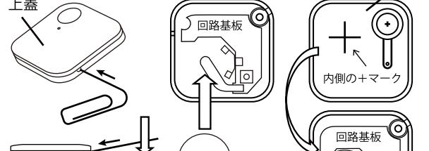
クリップなどの硬い棒を約5mm挿入して、↓の方向に押して開けます。
