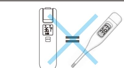
この体温計はおでこの表面温度を測定し口内(舌下)温度に換算して表示するため、一般的に脇下体温計の温度よりも高くなります。
