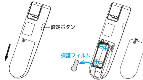
ご使用中にマークが点灯した場合は、電池収納部蓋を開け、単4形乾電池2本を極性に気を付けて挿入する。
